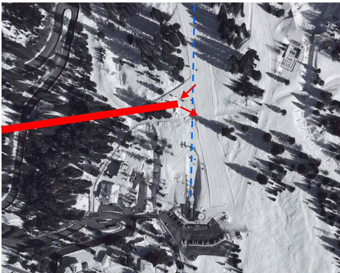
Foto 6. Collocazione della stazione presso la ski area “Colverde” della seggiovia “Colverde – Fosse di Sotto”; la linea rossa indica il percorso di linea del nuovo impianto; le frecce rosse il flusso sciatori; la linea blu tratteggiata indica il percorso della cabinovia esistente.
