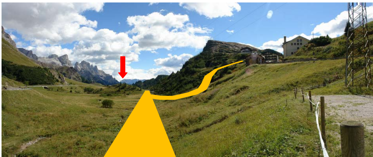
Foto 7. La foto, scattata dal parcheggio ex seggiovia "Segantini", illustra le zone interessate dal passaggio dei due nuovi tratti di pista; la freccia indica il cocuzzolo presso il quale si rende necessario lo sbancamento più significativo.
