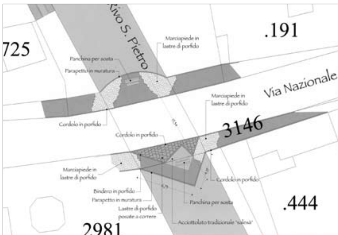
L'ipotesi di creazione di due piazzole di sosta a sbalzo sul rio San Pietro.
